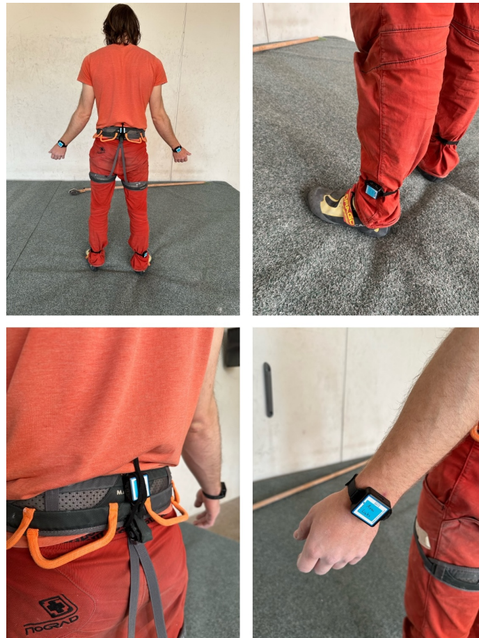
Abbildung 4.1: Positionen der Sensoren an Handgelenke, Hüfte und Knöchel
