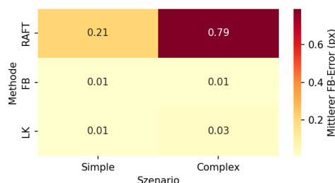
Abbildung 8.9: Mittlerer Forward-Backward-Error (in Pixel) für LK, FB und RAFT , jeweils unterteilt nach Szenenkomplexität (Einfach und Komplex). (Eigene Darstellung.)
