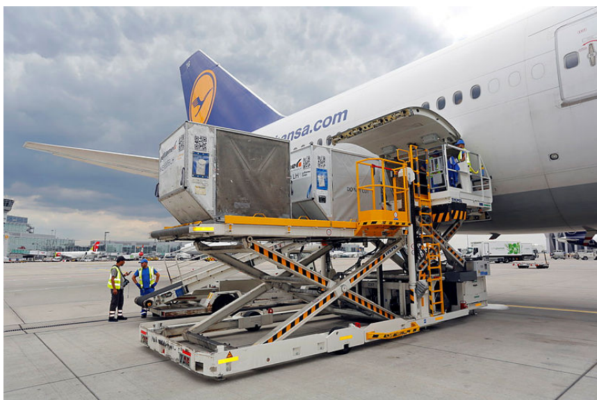
Abbildung 1. Container-Beladung eines Großraumflugzeugs mittels Hubwagens [1].
