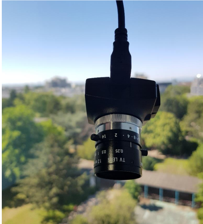
Abbildung 8: Verwendete Kamera mit montiertem 12mm-Objektiv.
